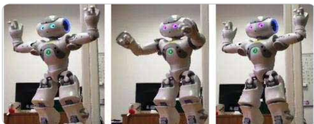
Obr. 11 Pracujeme na systéme s využitím senzoru Kinect, kde okrem rozpoznávania emócií človeka (z póz, pohybu, tváre) sú tieto prejavy kopírované na humanoidného robota, ktorý si automaticky tvorí databázu emocionálnych prejavov.
