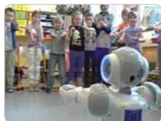
Obr. 9 Setup modelového scenára, kde robot predvčňuje viacerým deťom cviky na skoliózu (zatiaľ bez adaptívneho modelu – keďže adaptovať sa skupine detí je náročnejšie, ako vytvoriť personalizovaný model pre jedno dieťa.)
