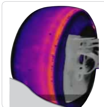
Obr. 39 Rozloženie teploty na povrchu pneumatiky závodného automobilu
