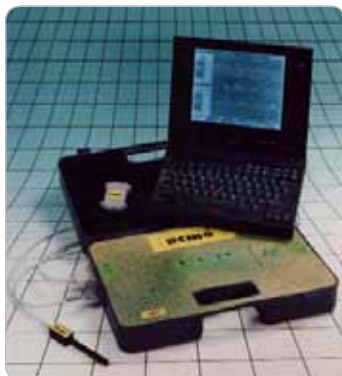
Obr. 3 Zostava magnetometra VEMA – 030
