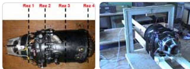
a) b) Obr. 6 a) Hypotetické rezy motora b) MPM-20 na drevenej konštrukcii
